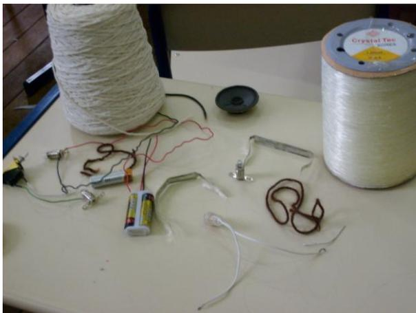
Figura 1 – Materiais disponibilizados para a montagem do circuito que acenderia uma lâmpada.
